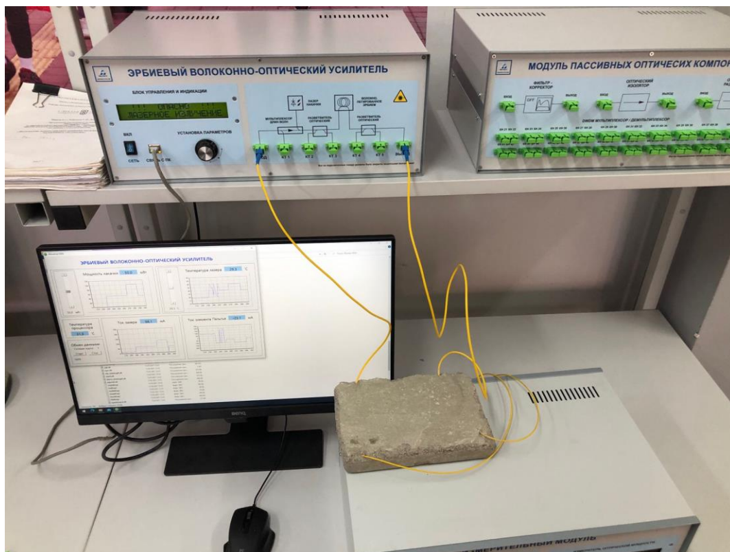
3.5 - сурет – Бетон конструкциясының күшейткіш арқылы температуралық және кернеуін өлшеу барысы
